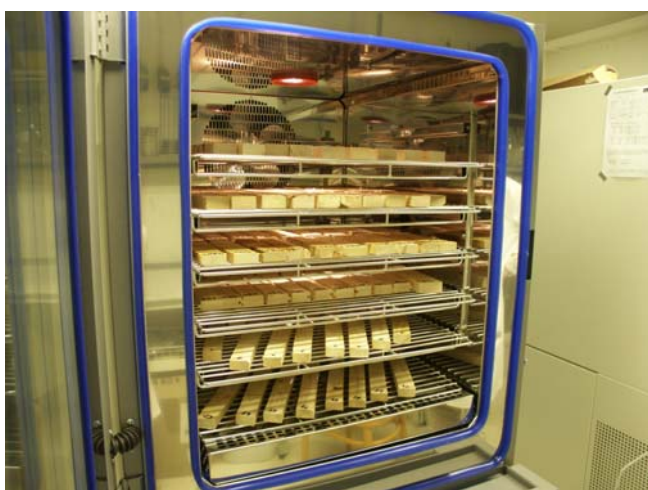
Figur 3.5 Provbitarna på plats i klimatskåp.
